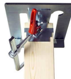
Fixação do gabarito macho
