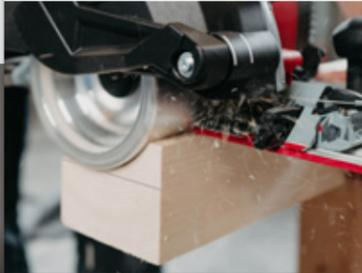
La puissance de la NFU50 vous permet de faire des moises et rainures d'une largeur de 60mm et d'une profondeur de 50mm.
